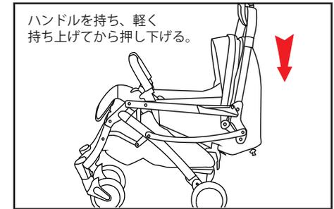
4.開閉ロックボタンを握った状態のまま軽く持ち上げてから押し下げます。フットレスト使用時は収納して下さい。
