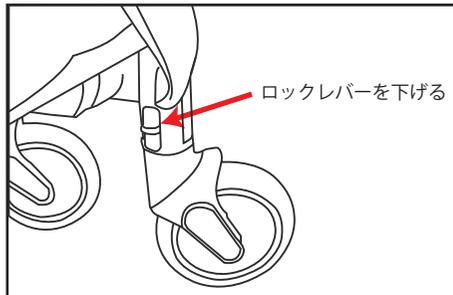
前輪ホイールを進行方向にロックする時は灰色のホイールロックレバーを下げてホイールをロックして下さい。
