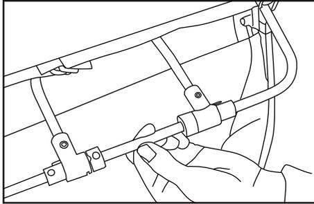
フットレスト：座面下のフットレストフレームを手前に引き出します。
