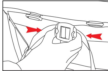
2.バックル左右のボタンを押しながら手前に引くとシートが倒れます。
