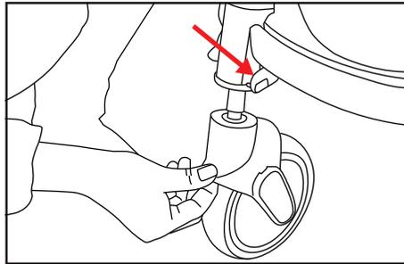
前輪を外す時は、フレーム下部にある銀色のホイールロックレバーを押しながらホイールを外します。
